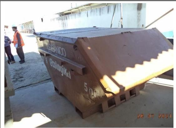
**Foto 63:** Caçamba de deposição de resíduos orgânicos devidamente fechada de modo a impedir a atração de fauna sinantrópica.
