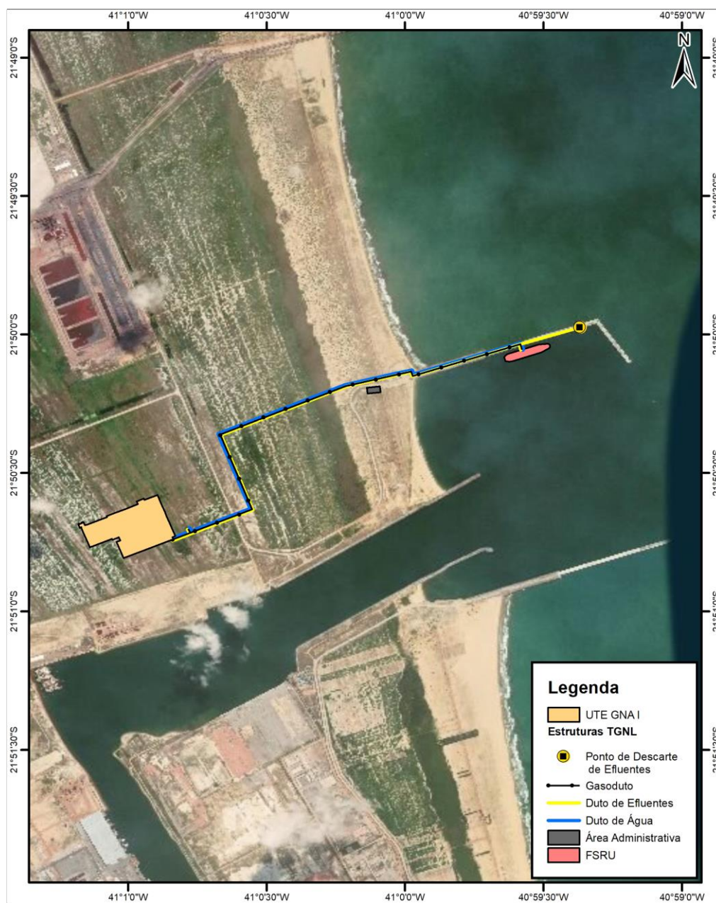
Figura 1 - Localização das principais estruturas do terminal. Fonte: Ecology Brasil & GNA (2019).
