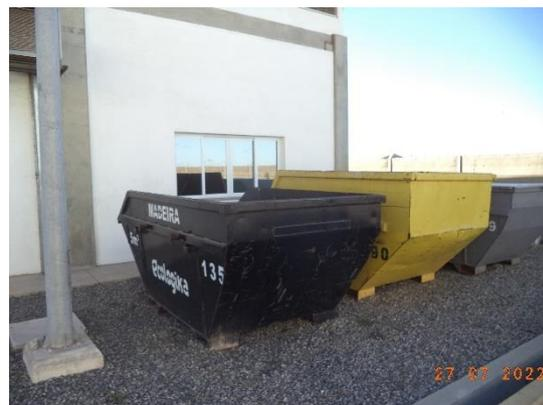
**Foto 24:** O local não apresenta cobertura e isolamento e nem está interligado à drenagem oleosa da planta.
